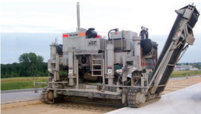
▲ PS-2700 et PS-3000 Power Pavers Pré-alimentateur béton.
