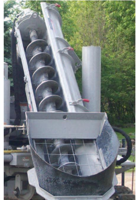
Le couvercle du convoyeur à vis s'ouvre pour le nettoyage.
